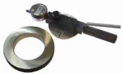
**Medidor manual y digital de diámetro interior de lata**
