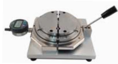
**Medidor manual y digital de diámetro interior de lata**
